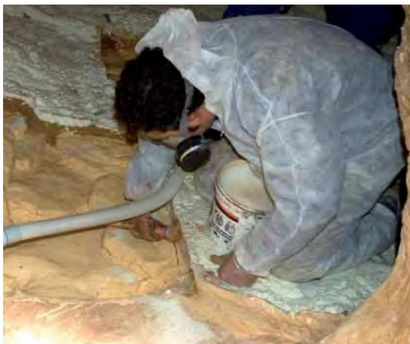
*Lámina 10.19. Aplicación sobre el plano de unión de la película desmoldeante.*
