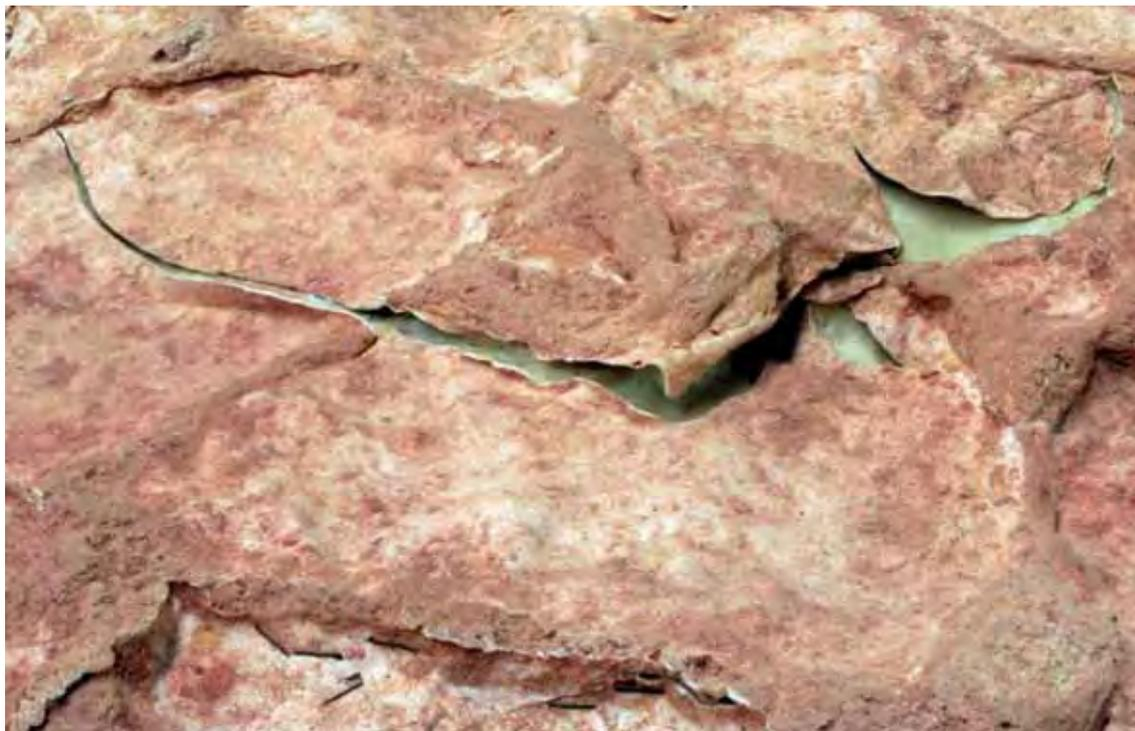
*Lámina 10.61. Detalle en primer plano de un desgarro de la silicona.*
