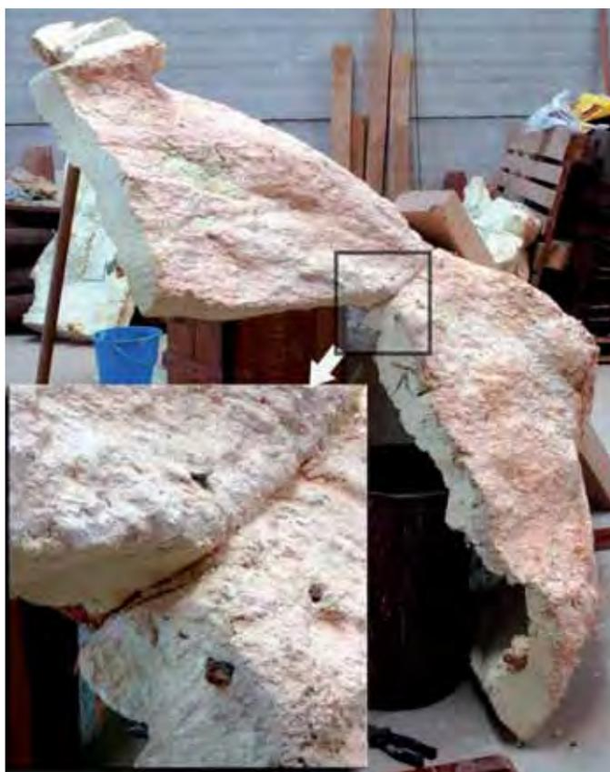
*Lámina 10.44. Vista general y detalle del cosido con clavos.*
