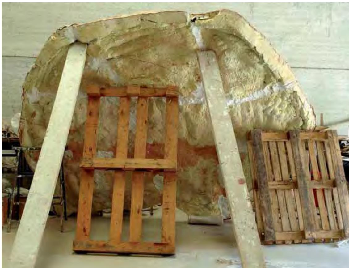
*Lámina 10.81. Colocación en vertical del molde del suelo para proceder a su apertura.*
