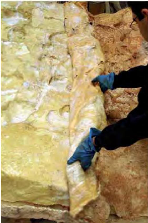
*Lámina 10.57. Despliegue de la silicona sobre el contramolde.*
