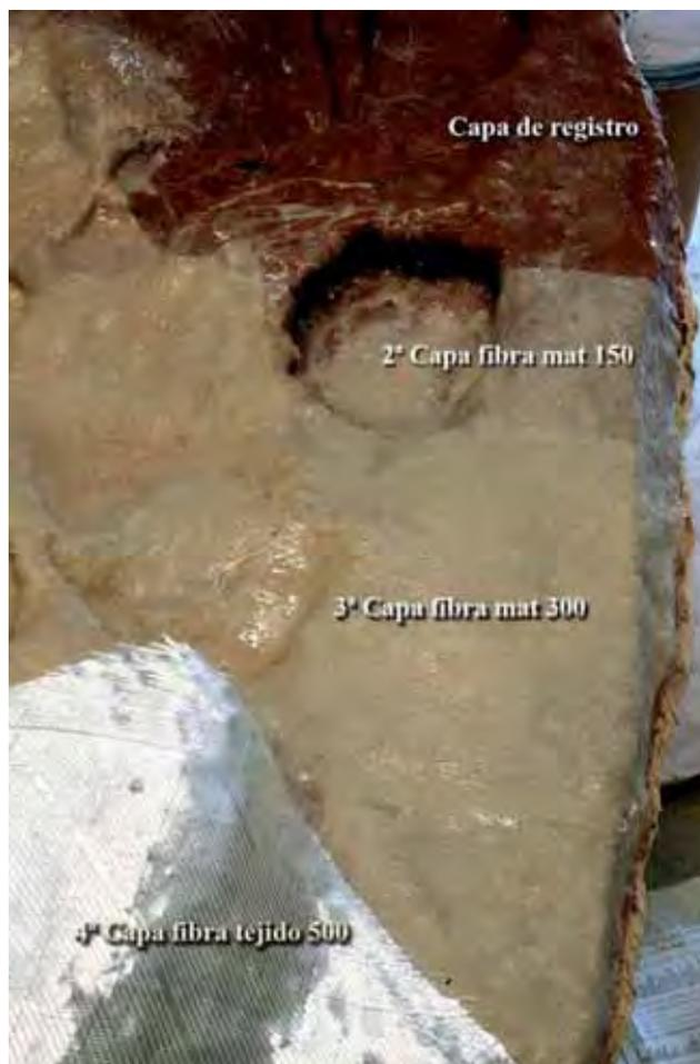
*Lámina 10.68. Vista esquema de los diferentes estratos.*
