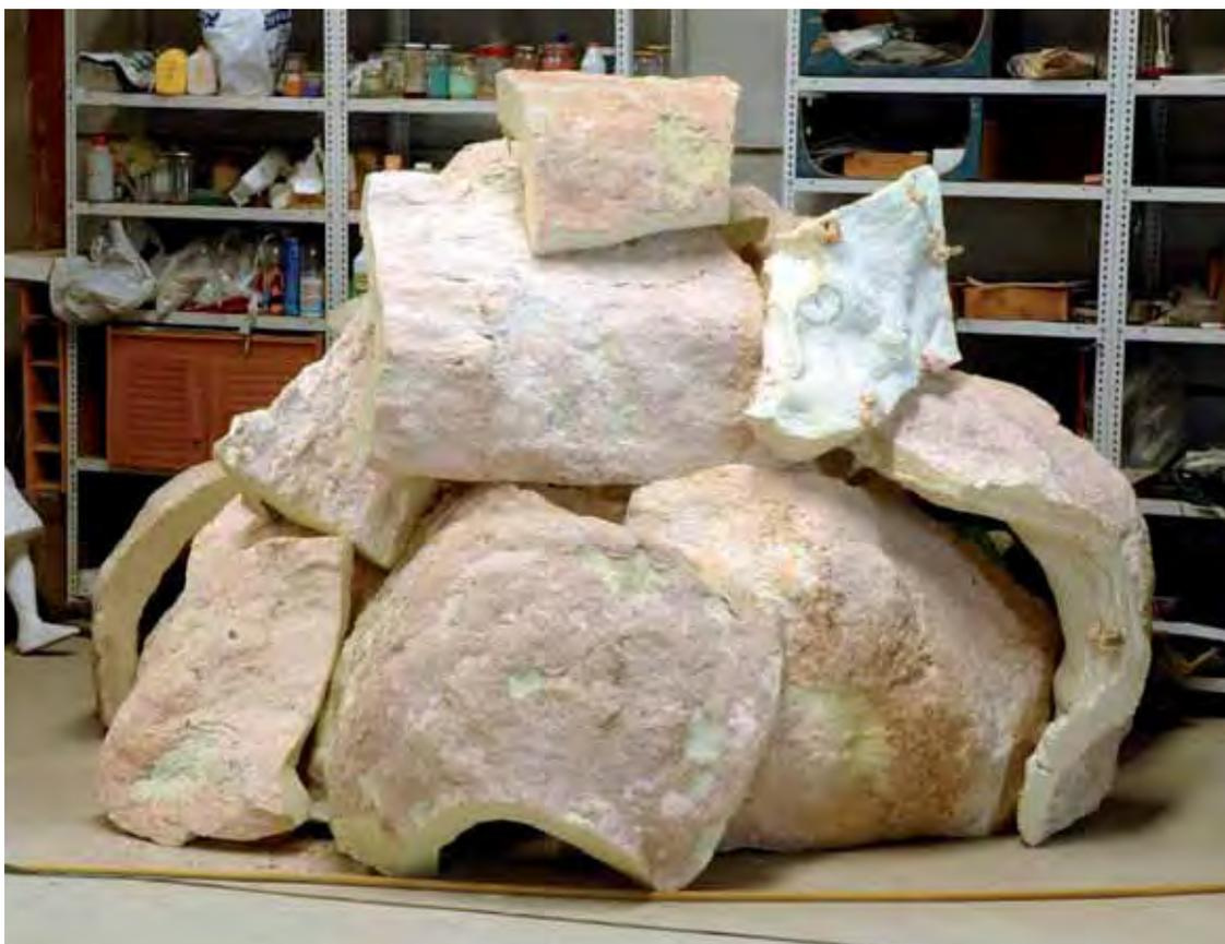
*Lámina 10.42. Piezas que componen el molde de la bóveda apiladas en el taller.*
