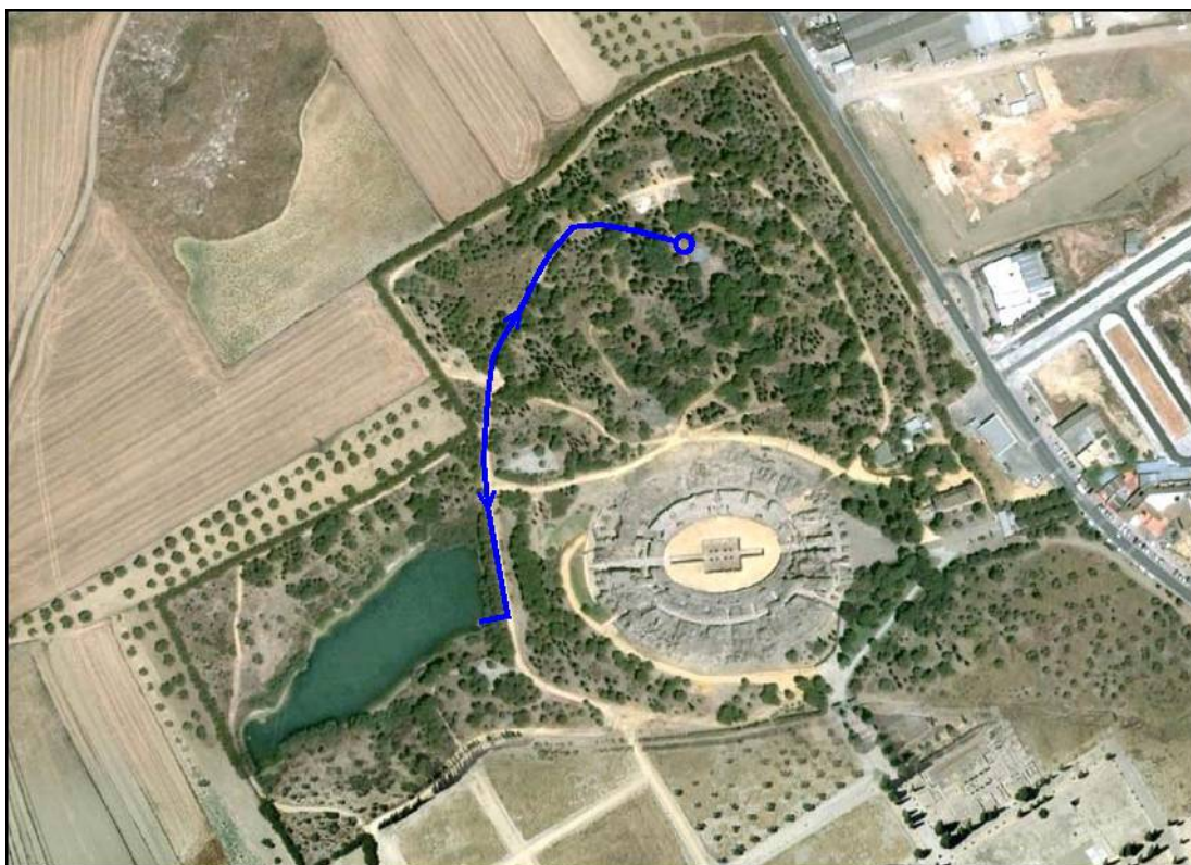
Trazado de la tubería para el transporte de agua desde el depósito a la laguna
