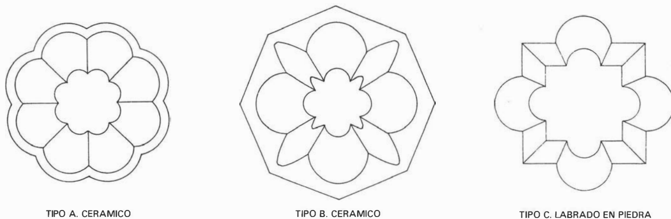
FIG. 4. Plantas de las lucernas de las bóvedas.
