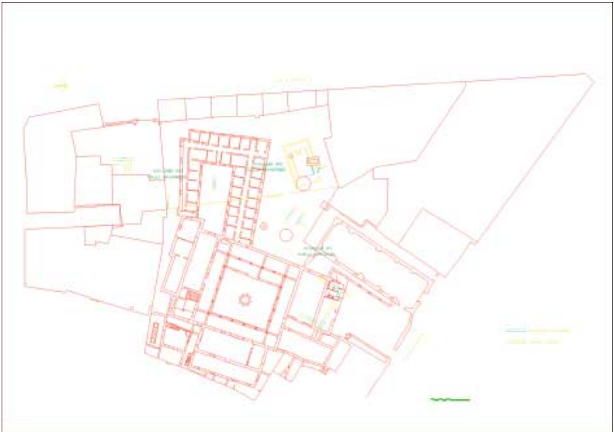
FIG. 8. Planta del edificio actual con las estructuras islámicas localizadas y sus trazados hipotéticos.
