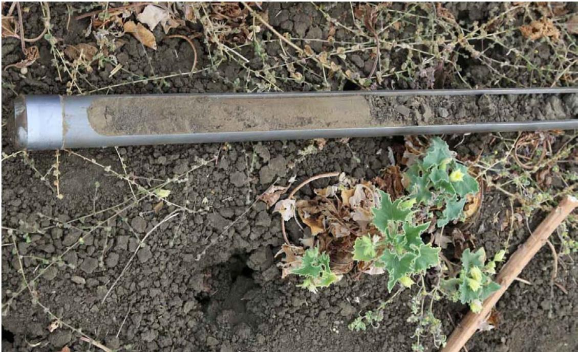
**Fig. 4.** Muestra extraída mediante perforación para su análisis geoarqueológico.
