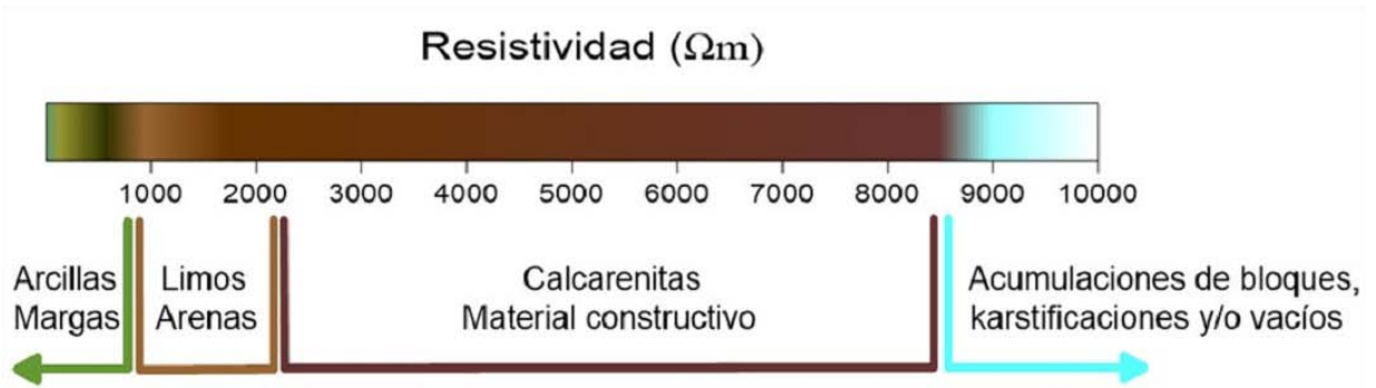
Figura 6. Escala de resistividades interpretada, donde se muestra la correlación con los diferentes materiales
