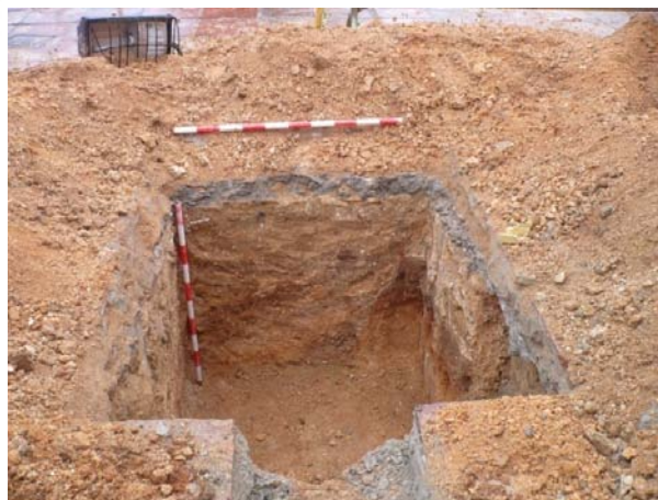
FIG. 5. Perfil de la cata principal en el que se observa el substrato de niveles de arcilla con carbonatos.
