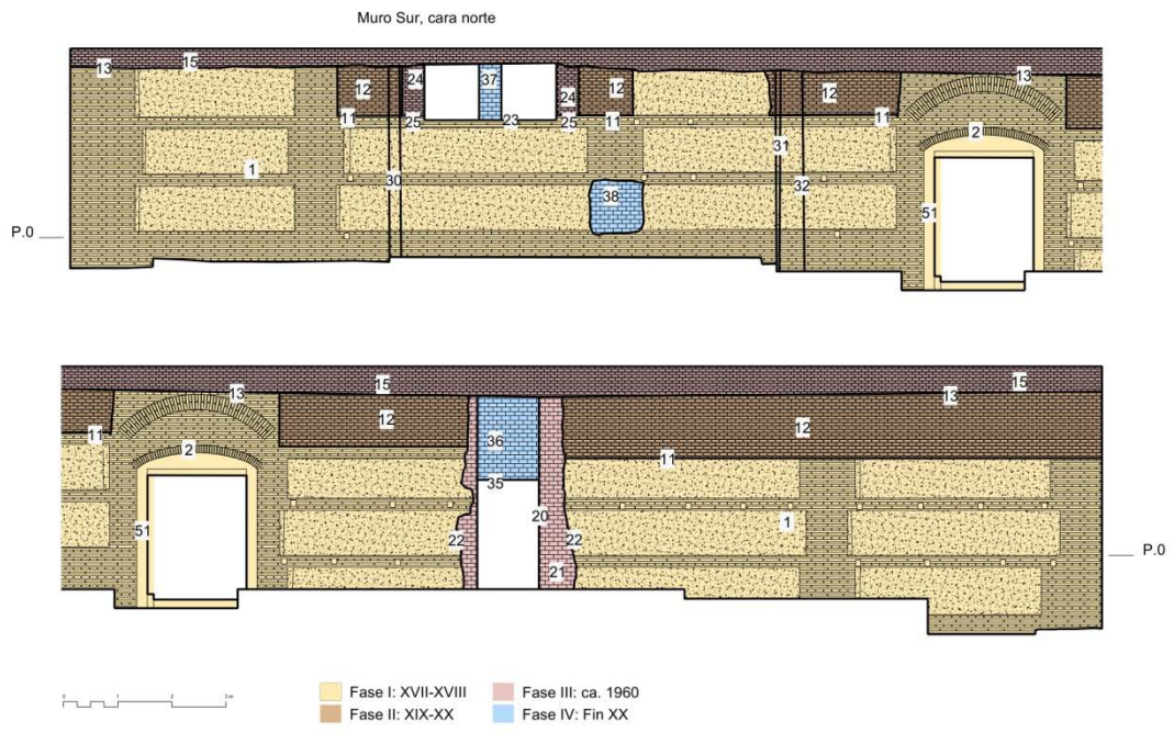
Figura 18. Alzado norte del muro sur de la nave
