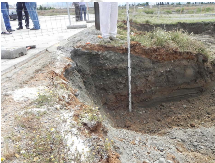
LÁM.2. Perspectiva del perfil de una sección del terreno en sentido norte-sur. Se observa el nivel de tierra vegetal.
