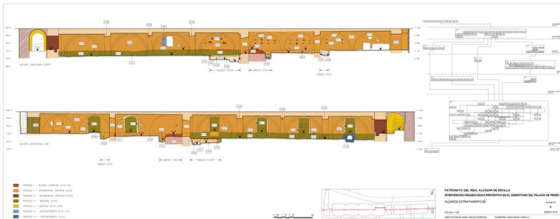
**Figura 9.** Alzados estratigráficos. A destacar la coetaneidad de toda la fábrica del sótano.
