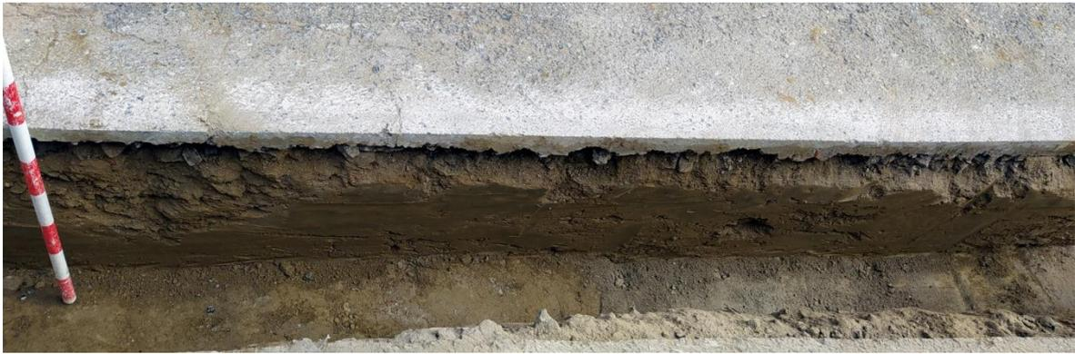
**Ilustración 13:** *Sedimento limo arcilloso, sustrato natural procedente de crecidas de la rambla.*
