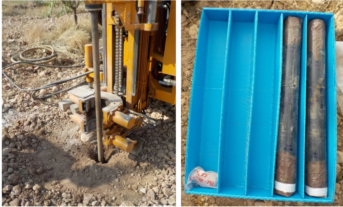
Figura 8. Vista de la perforadora de sondeos trabajando y detalle de los testigos extraídos.
