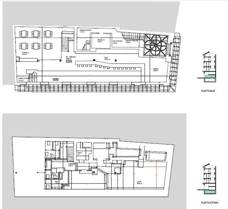
Fig. 6. Planta baja y sótano. Estado actual
