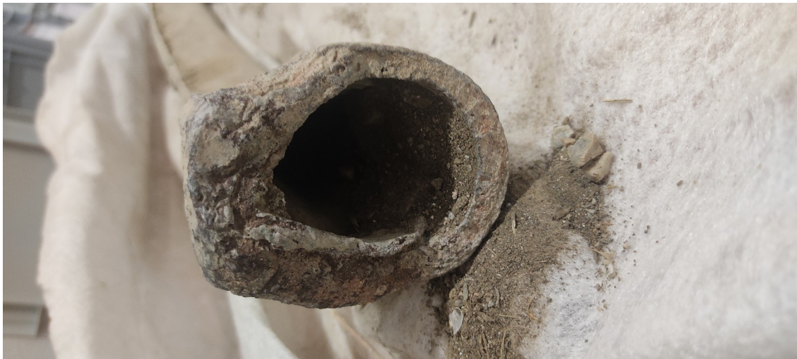
Figura nº 3: Detalle de las medidas de la pieza y sectores afectados por dióxido de plomo.
