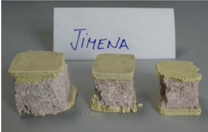
Fig. 17. Probetas de mortero refrentadas con azufre tras la rotura
