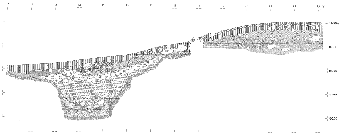
Fig. 3 Los Castillejos de Alcorrín (Manilva, Málaga). Corte C. Perfil de la muralla interior y foso previo. Dibujo: DAI Madrid.
