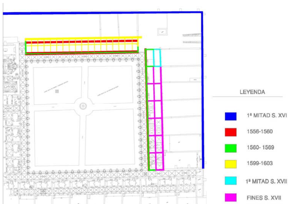
Fig. 2. Evolución constructiva de las principales estructuras de las crujías norte y este.
