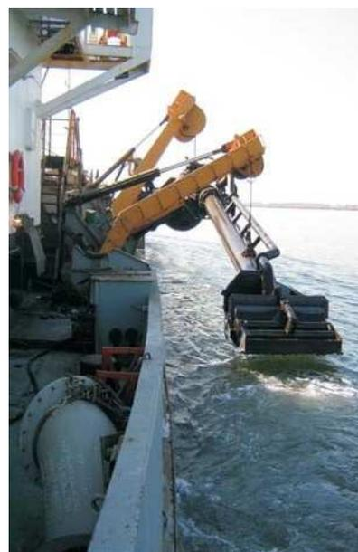
FOTO 1.4 INICIANDO DRAGADO CABEZAL DE SUCCIÓN, TUBERÍA Y CABRESTANTES
