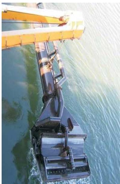
FOTO 1.3 CABEZAL DE SUCCIÓN INICIANDO DRAGADO
