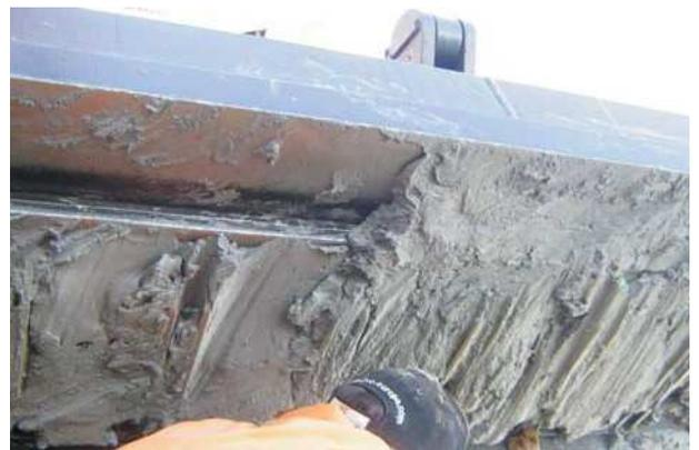
FOTO 4.4 DETALLE DEL CABEZAL DE SUCCIÓN SUCIO
