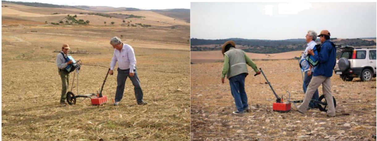
Lámina 2. A y B: Adquisición de datos con georadar en modo continuo con 400 MHz.
