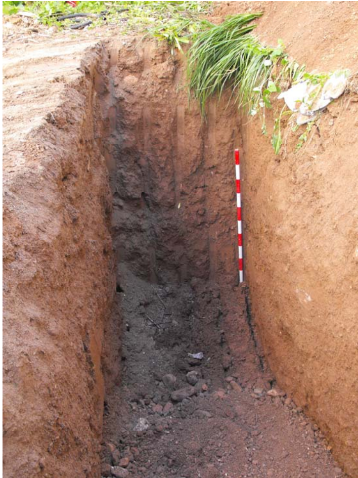
Lam. 1.- Imagen de la cata realizada para el sondeo geotécnico
