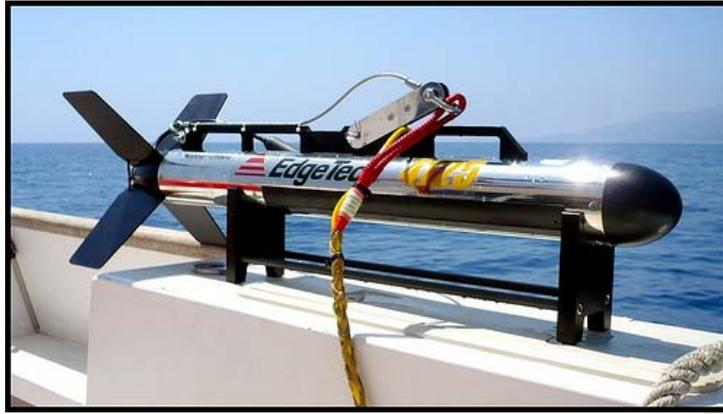
Figura 1. . Sónar de Barrido Lateral Edgetech 4125
