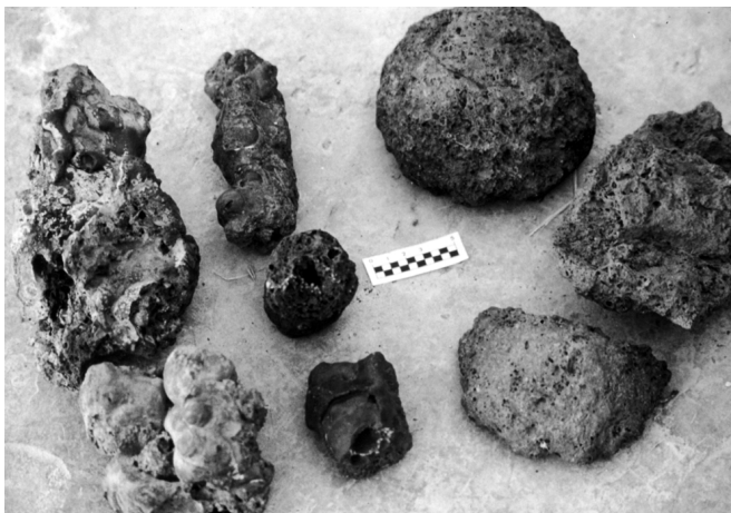
LÁM. III : Escorias macizas coladas de reducción, escorias coladas en canal, escorias de refinado y forja en casquete. Cerro de los Hornillos de Dólar (ss.VIII-XI).
