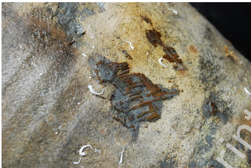
Ilustración 7. Fotografía detalle de restos de estera con las que eran cubiertas las botijas para su protección
