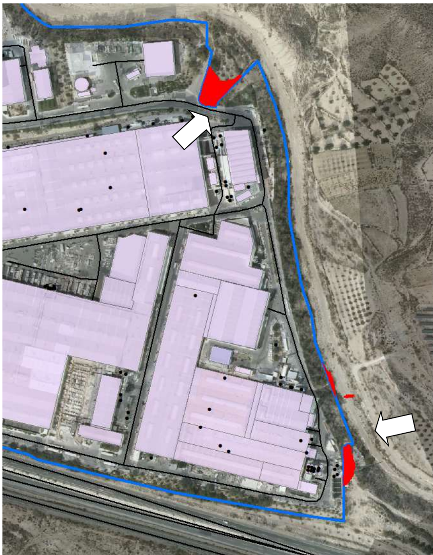
Detalle de las zonas afectadas por niveles sonoros > 70 dBA en periodo Noche bajo condiciones Favorables en el exterior del perímetro del polígono, estado futuro. Escala original 1:2.500
