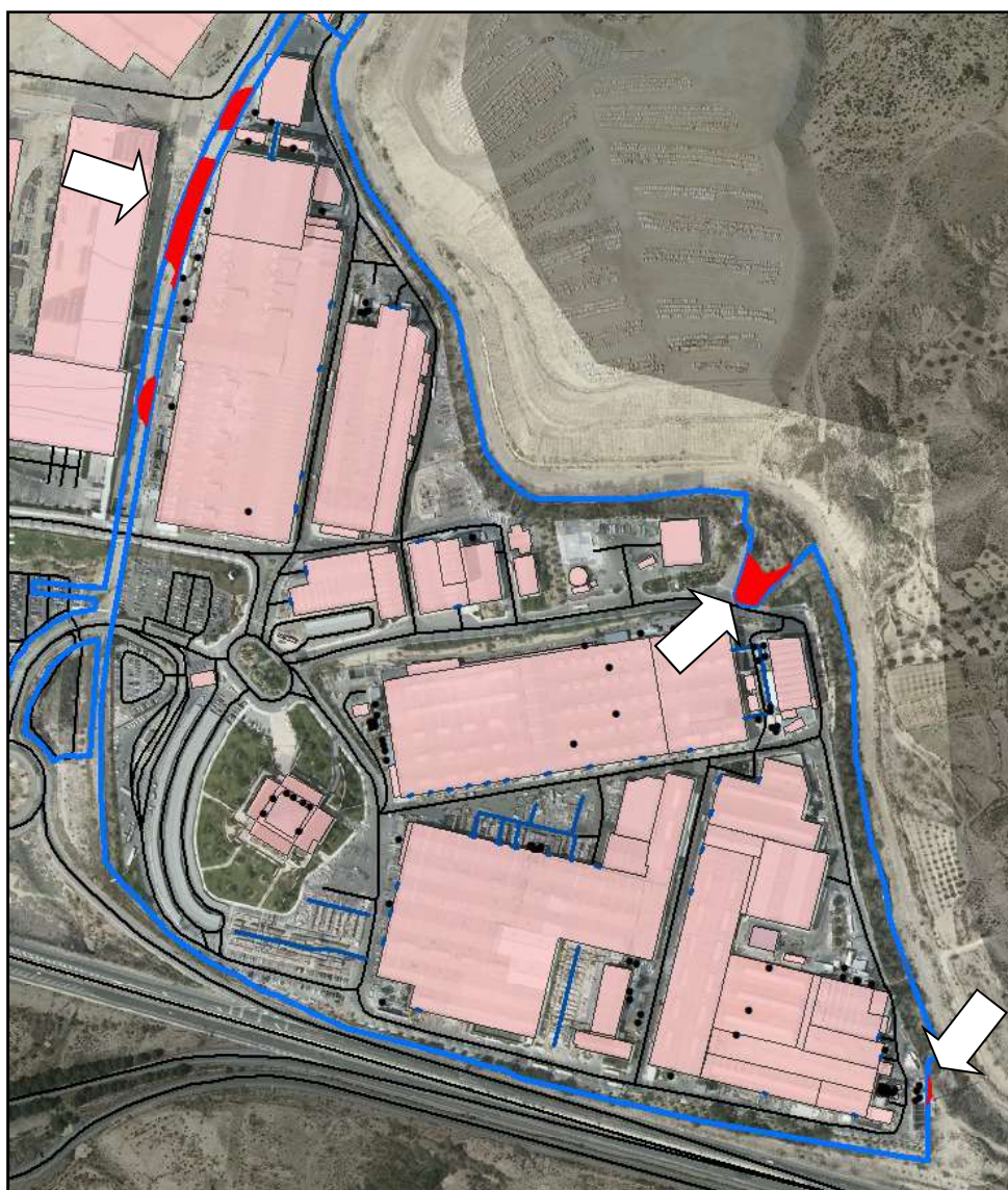
Imagen N°21: Detalle de las zonas afectadas por niveles sonoros > 70 dBA procedentes de la actividad industrial en periodo Noche bajo condiciones Favorables en el exterior del perímetro del polígono, estado actual. Escala original 1:4.000
