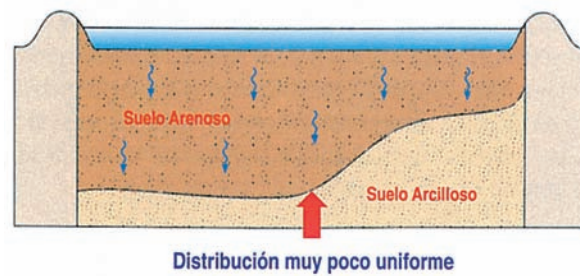
Figura 6. Efecto de la diferente cantidad de agua infiltrada como consecuencia de distintos tipos de suelo en una misma parcela.
