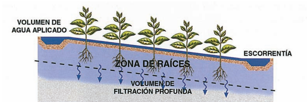
Figura 7. Representación esquemática de los elementos que intervienen en el cálculo de la relación de filtración.
