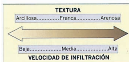
Figura 7. Relación entre la textura del suelo y su velocidad de infiltración de agua.
