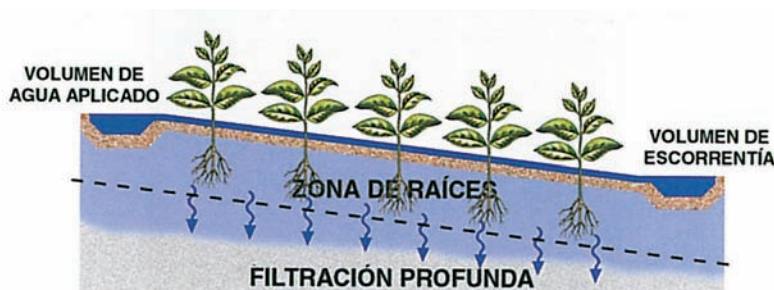
Figura 6. Representación esquemática de los elementos que intervienen en el cálculo de la relación de escorrentía.
