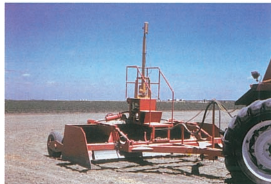
Figura 5. Conjunto formado por niveladora y sistema receptor de láser, tirado del tractor.
