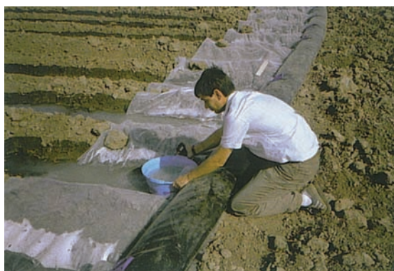
Figura 20. Medida del caudal de entrada a un surco utilizando un recipiente de volumen conocido y un cronómetro.
