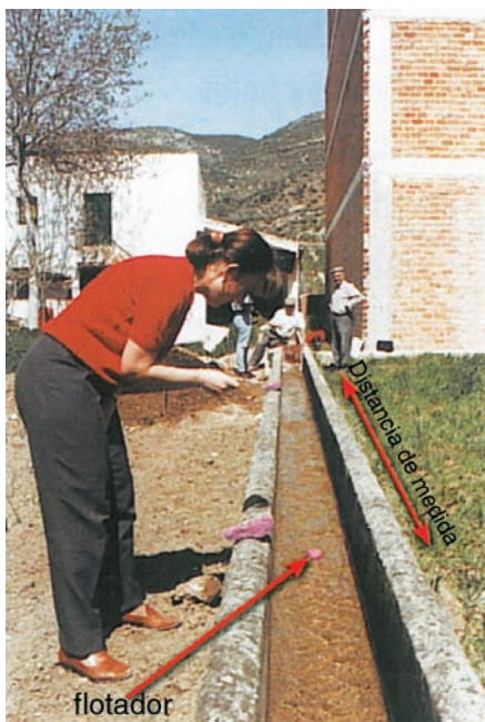
Figura 19. Medida del caudal mediante la utilización del método del flotador.
