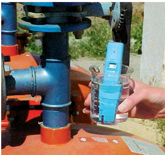
Figura 3. Medida de la conductividad eléctrica de un agua de riego usando un conductímetro portátil.
