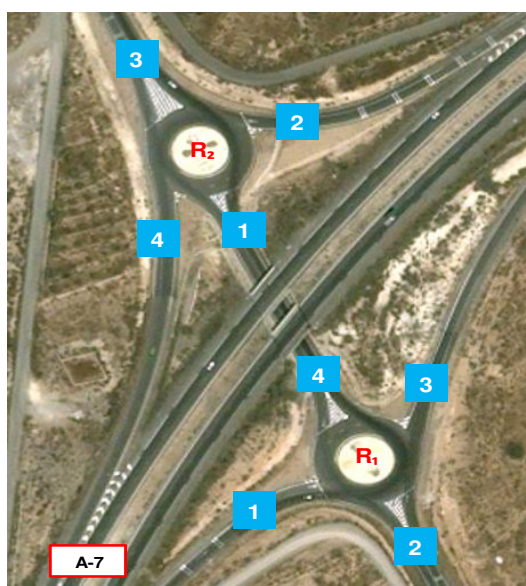
Figura 7. Identificación de rotondas y codificación de accesos. Enlace A-7 con AL-3108/AL-3107
