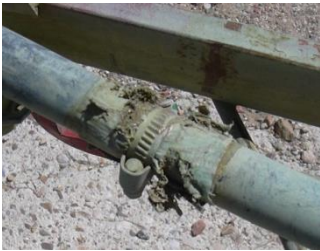
Figura 23. Tubería rota que puede ser el origen de una fuga
