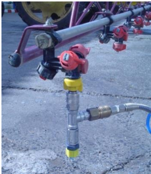
Figura 12. Detalle del acoplamiento entre el comprobador de presiones y la boquilla del equipo
