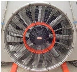
Figura 27. Atomizador con rejilla de protección adecuada que evita acceder a las partes móviles
