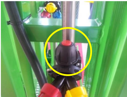
Figura 9. Boquillas con sistema antigoteo
