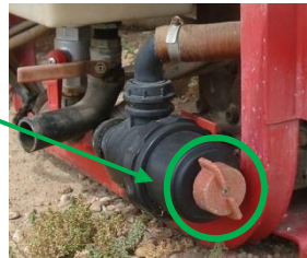
Figura 24. Sistema de apertura de filtro que evita el derrame del caldo (derecha), y filtro en buen estado (izquierda)
