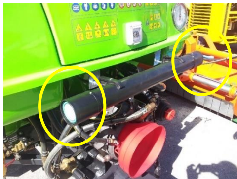
Figura 7. Sensor de ultrasonidos para la detección de la presencia de árboles
