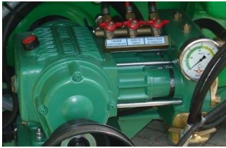
Figura 18. Bomba de pistones, adecuada para la pulverización con atomizador, sin signos visibles de fugas
