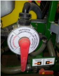
Figura 11. Sistema de enjuague y lavado del circuito y depósito tras la aplicación.
