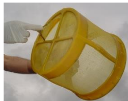
Figura 20. a) Sistema de vaciado adecuado. b) Filtro de la boca de llenado, roto
