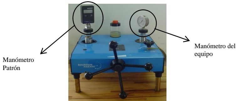
Figura 21. Comprobador de manómetros
