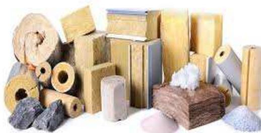
Para que un material se considere aislante debe ofrecer una resistencia al paso de calor entre dos ambientes con distinta temperatura con una conductividad térmica igual o inferior a 0,15kcal/m·h·°C.
