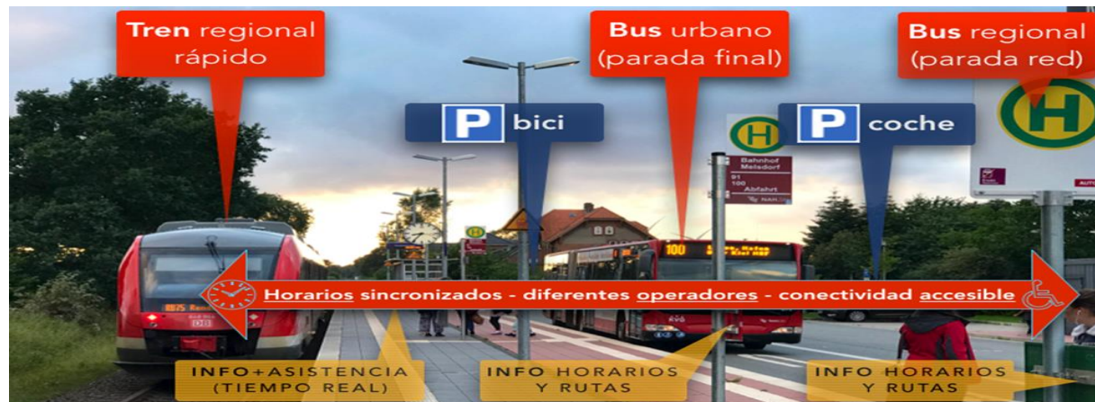
Ilustración: intercambiador tipo periférico de nah.sh de andén intermodal único. (foto e infografía: Rainer Uphoff)
