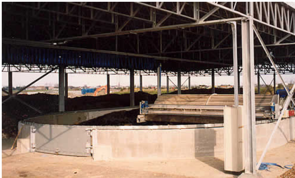
Figura 4.14 Volteador de túnel mediante palas
