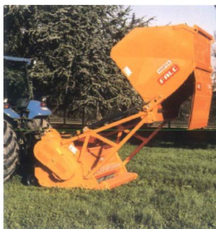
Figura 4.2 Detalle de equipos de triturado en campo con recogida automática
