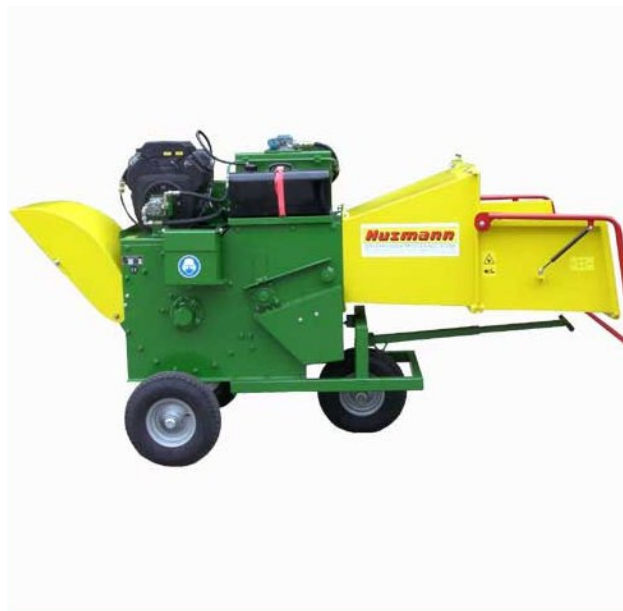
Figura 4.17 Pequeños molinos de alimentación manual útiles para descompactar compost en pequeñas instalaciones
