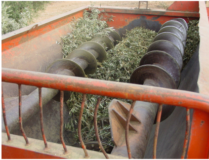
Figura 4.7 Mecanismo de funcionamiento de mezcladoras de compost
