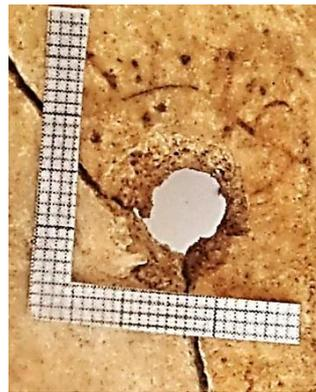
Detalle del orificio 1 en su tabla externa (izq) e interna (der).
