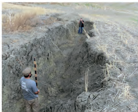
Nivelación mediante nivel óptico portátil. La diferencia entre la altura fija de la vara de apoyo del nivel óptico (1.5 m) y la marca vista en la mira debe coincidir con la altura del dique buscada.
