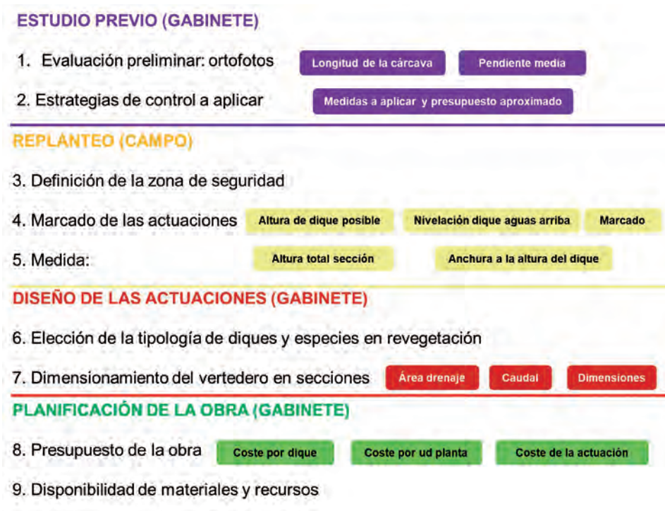
Figura 53. Diagrama de etapas básicas para el diseño de actuaciones de control de cárcavas.
