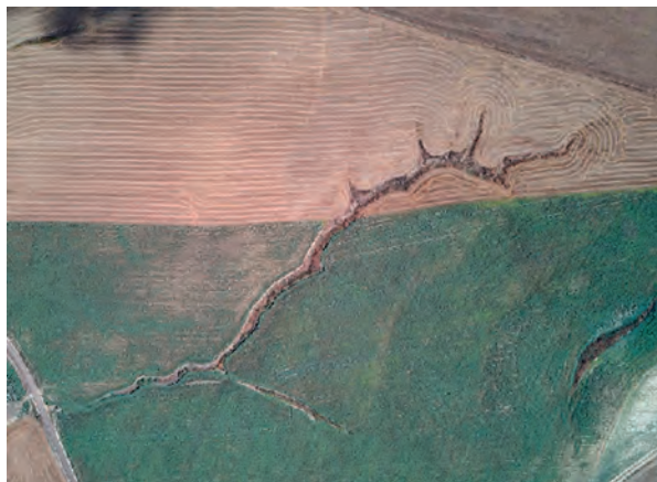
Figura 5.1. Ortofoto (julio 2007) de una cárcava en la provincia de Córdoba. Se observa que las dimensiones mayores se encuentran en la zona media, decreciendo hacia la cabecera de los tributarios y hacia la salida de la cárcava.
