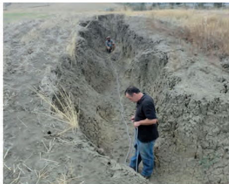
Nivelación mediante nivel de agua. Los meniscos de la columna de agua están a la misma elevación. El operador aguas abajo controla la altura del dique y el operador aguas arriba que la burbuja esté en el terreno.
