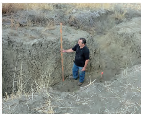
Medida de la altura total de la sección mediante regla graduada.
