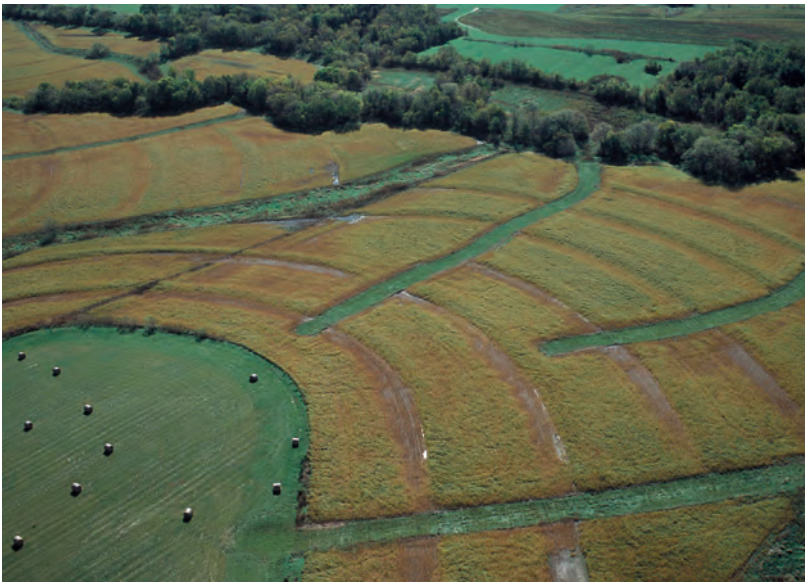
Figura 26. Ejemplo de canal vegetado para evacuar escorrentía en pequeñas vaguadas sin que se formen cárcavas. Cortesía NRCS.
