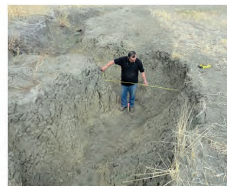
Medida de la anchura a la altura del dique mediante cinta métrica flexible
