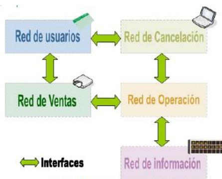
La Red de Información está unida mediante una VPN basada en tecnología GPRS/HSDPA a la Red de Operación, lo que permite que los elementos de la Red de Información tengan libertad de ubicación.
