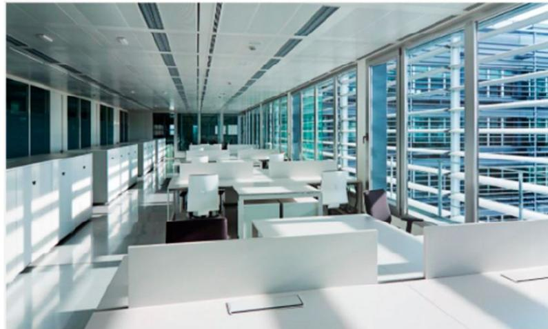
El sistema de climatización todo aire y a caudal variable permite establecer los ambientes con control térmico independiente adecuados. La iluminación, de carácter lineal y totalmente integrada, permite unos niveles de iluminación óptimos, con muy bajos niveles de consumo asociado, en función de parámetros como ocupación y niveles de iluminación natural.
