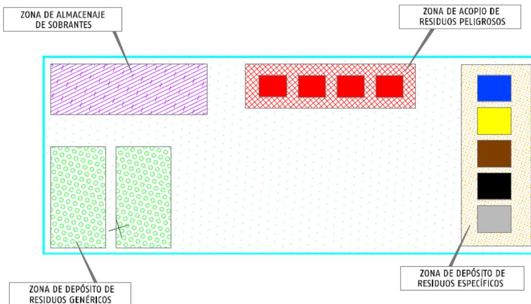
El punto limpio se dispondrá sobre una superficie impermeabilizada, con solera de hormigón, y su recogida será periódica y selectiva por gestores autorizados.
