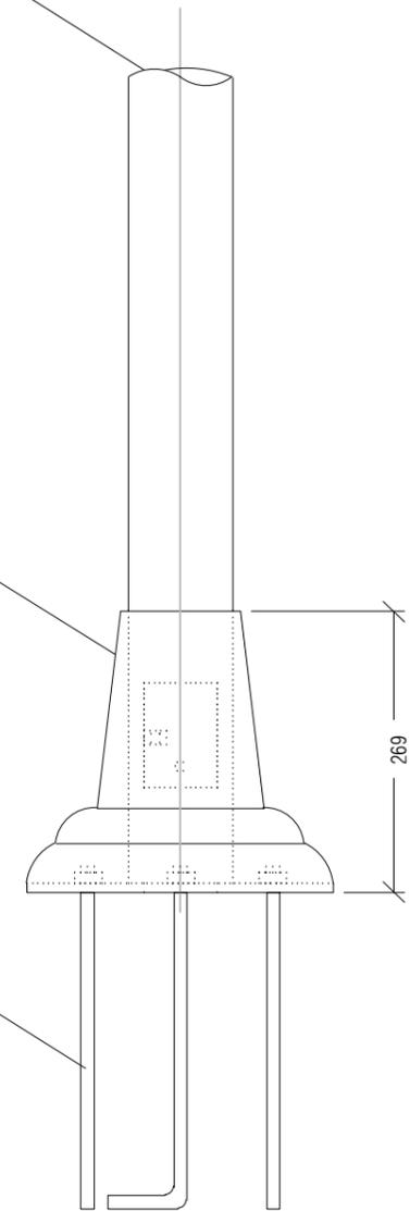
DETALLE DE SISTEMA DE SUJECCIÓN
