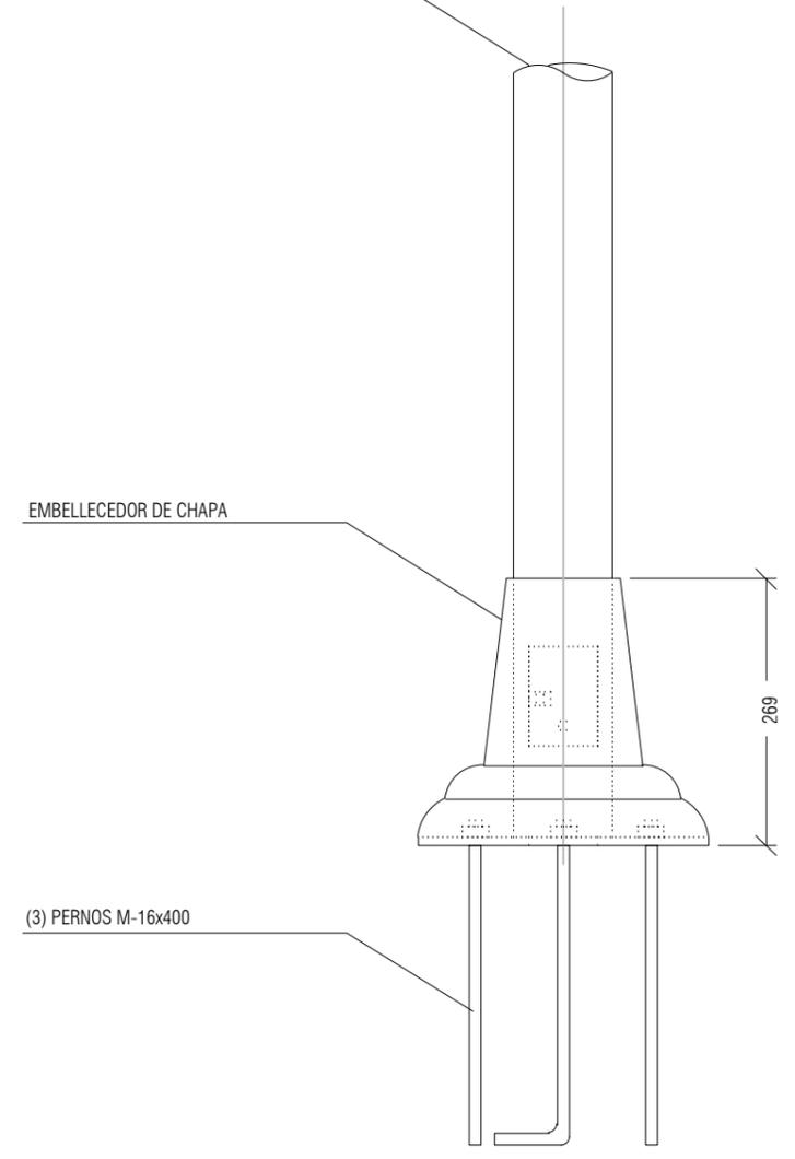
DETALLE DE SISTEMA DE SUJECCIÓN
