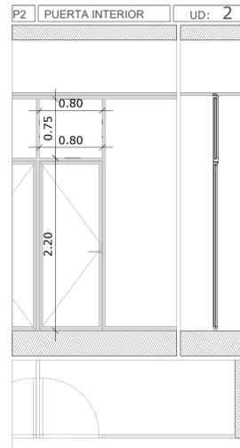
**SISTEMA** Puerta interior abatible de una hoja, 216x80x4,5 cm, con marco metálico de aluminio lacado blanco y vidrio laminar de seguridad 6+6 con cerradura y manilla
