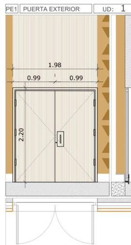
**SISTEMA** Puerta exterior abatible de dos hojas iguales de 212x92,5x7 cm metálica lacada RAL 1002, con rotura de puente térmico, alma aislante de 5 cm de espesor, cortafuegos, con cerradura de seguridad y apertura con control de acceso
