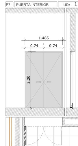
**SISTEMA** Puerta interior abatible de dos hojas de 148,5x220x7 cm de acero lacada con alma aislante de 5 cm cortafuegos y panelado interior con blindaje electromagnético bicapa.
