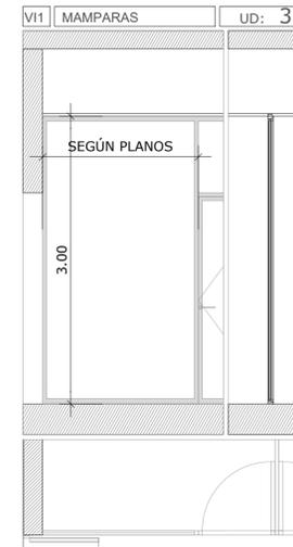
**SISTEMA** Mampara fija con marco metálico de aluminio lacado blanco y vidrio laminar de seguridad 6+6 con cerradura y manilla.
