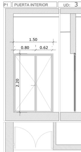
**SISTEMA** Puerta interior abatible de dos hojas desiguales, 216x80x4,5 y 212x82,5x4,5 cm, con marco metálico de aluminio lacado blanco y vidrio laminar de seguridad 6+6 con cerradura y manilla.
