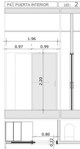
**SISTEMA** Puerta interior corredera para armazón metálico, ciega, de una hoja de 212x89,5x3,5 cm, de tablero de MDF, prelacada en blanco lisa con pestillo y tirador
