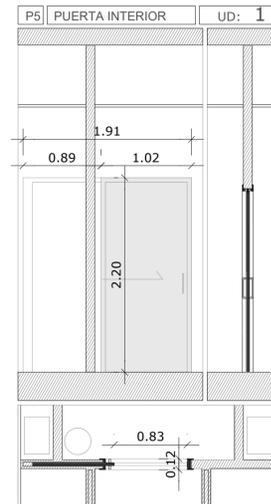
**SISTEMA** Puerta interior corredera para armazón metálico, ciega, de una hoja de 212x92,5x3,5 cm, de tablero de MDF, prelacada en blanco lisa con pestillo y tirador
