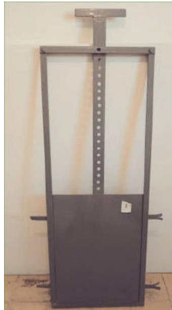
Compuerta tipo a instalarse en los canales.
