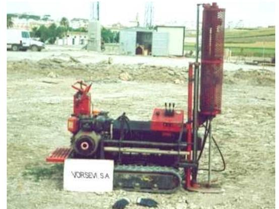
El ensayo se da por terminado cuando se alcanza el rechazo, que fijamos en un valor de  $N_{DPSH} = 100$  golpes.
