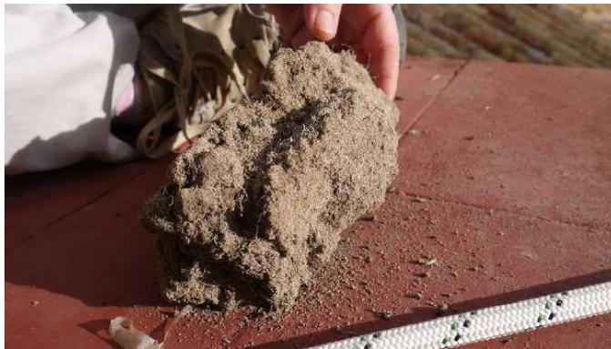
Material de agarre de las tejas compuesto por tierra con algo de cal. El material se encontraba con raíces de la vegetación nacida en la cubierta.
