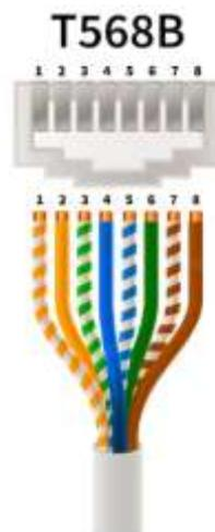
Al efectuar la mecanización de los conectores RJ (45 6 49) el destrenzado de los cables no sobrepasará los 6 mm, si bien se intentará mantener el trenzado de los cables tanto como sea posible. Esta se realizará con las herramientas adecuadas con el objeto de garantizar la categoría del enlace.
