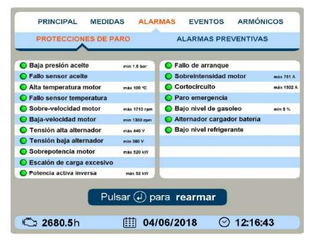
Las protecciones de sobreintensidad y cortocircuito se realizan mediante una detección electrónica trifásica, situada en el interior del alternador, que protege al propio alternador y a la línea de salida de potencia. El módulo de control del cuadro automático de arranque del grupo, permite un ajusto preciso de los valores de disparo, logrando así una mejor protección que con detección magnetotérmica.
