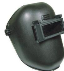
En los trabajos de soldadura eléctrica, se usará el tipo de pantalla de mano llamada cajón de soldador con mirillas de cristal oscuro protegido por otro cristal transparente, siendo retráctil el oscuro para facilitar el picado de la escoria y fácilmente recambiables ambos. En aquellos puestos de soldadura eléctrica que lo precisen y en los de soldadura con gas inerte Nertal se usarán las pantallas de cabeza con atalaje graduable para su ajuste en la misma.
