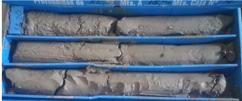
Muestras del nivel geotécnico 2 . Limos arcillosos muy blandos.
