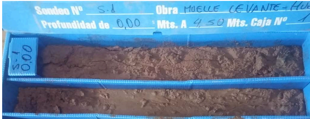
Muestras del nivel geotécnico 1. Arenas de playa color marrón.
