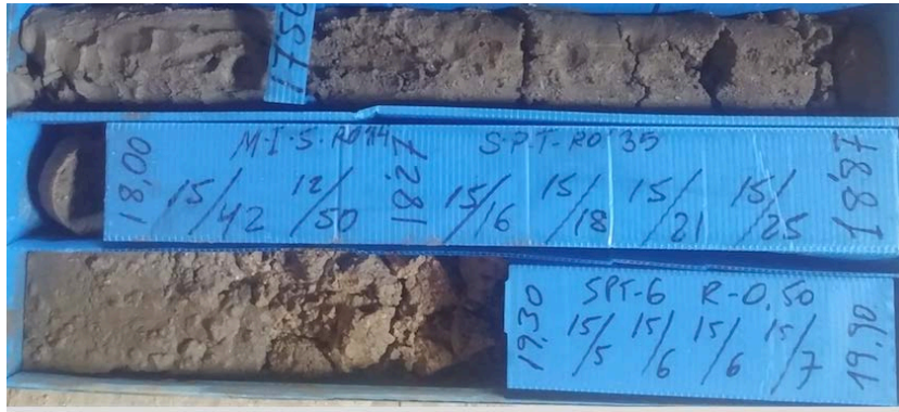
Muestras del nivel geotécnico 3 . Arenas limosas.
