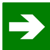
Figura 23. Señal de dirección de salida de emergencia
