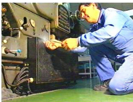
Figura 17. Contacto eléctrico indirecto
