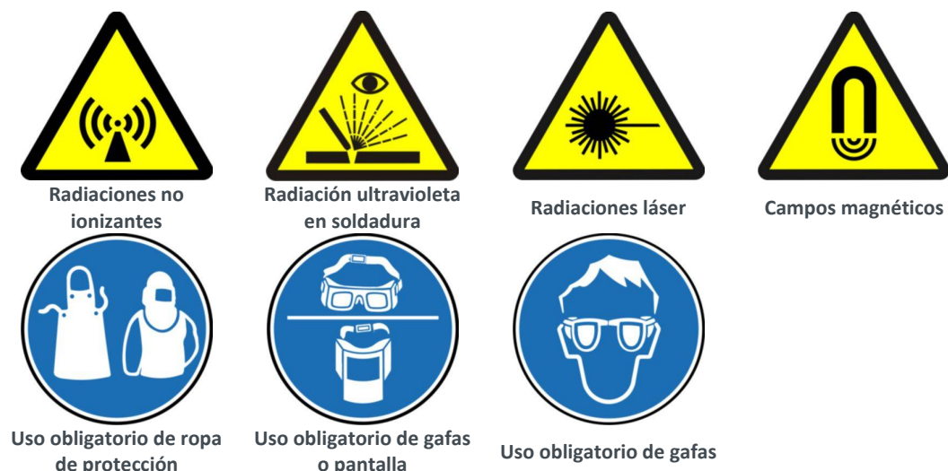
Figura 41. Señalización relacionada con riesgo por radiaciones no ionizantes
