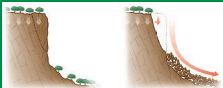
Pendiente pronunciada y abundantes fracturas: derrumbe inevitable
