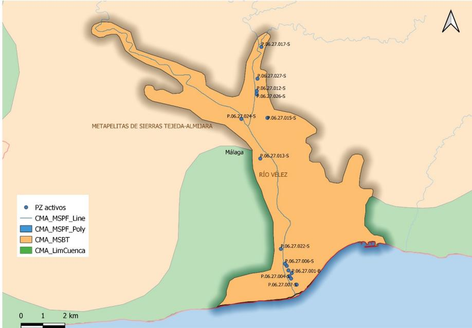
Hay un descenso generalizado de los niveles, especialmente acusado desde mayo de 2022. En seis puntos de control: P-06.27.001-B, P-06.27.003-S, P-06.27.004-S, P-06.27.006-S, P-06.27.008-S y P-06.27.023-S han alcanzado cotas piezométricas negativas, lo que es indicativo de un muy probable proceso de intrusión salina, que puede situarse al menos entre 1,5 – 2 km tierra adentro.
