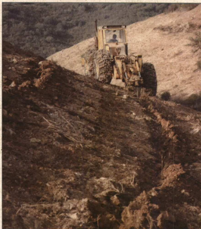
El tractor de alta estabilidad respeta los perfiles del terreno, reduciendo al máximo los riesgos de erosión.
